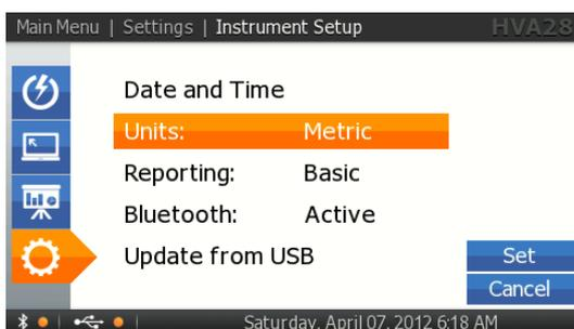
Выберите единицы измерения между метрической системы Metric (метры) и Feet (футами).
